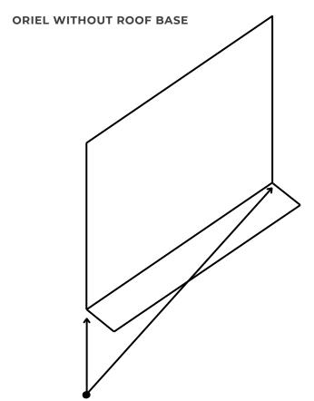
THE BASE CAN SIT RIGHT TO THE EDGE OR EVEN OVER THE EDGE OF THE OPENING AS CILLS CAN BE USED
